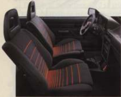
Das XR 3-Cockpit mit speziellen Sportsitzen, griffigem 2-Speichen-Sportlenkrad und kompletter Instrumentierung. Stereocassettegerät Sonderausstattung.
