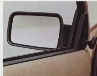
Der von innen einstellbare Außenspiegel auf der Fahrerseite und Stoffeinsätze in den Türseitenverkleidungen.
