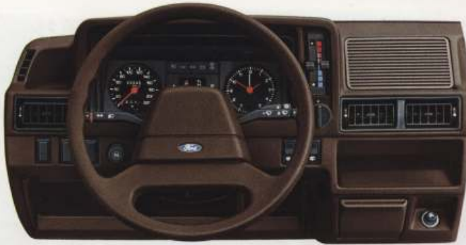
Das übersichtlich gestaltete Armaturenbrett mit griffgünstigen Schaltern, schaumstoffummanteltem 2-Speichen-Lenkrad, Analoguhr, Zigarettenanzünder und zwei Ablagefächern.
